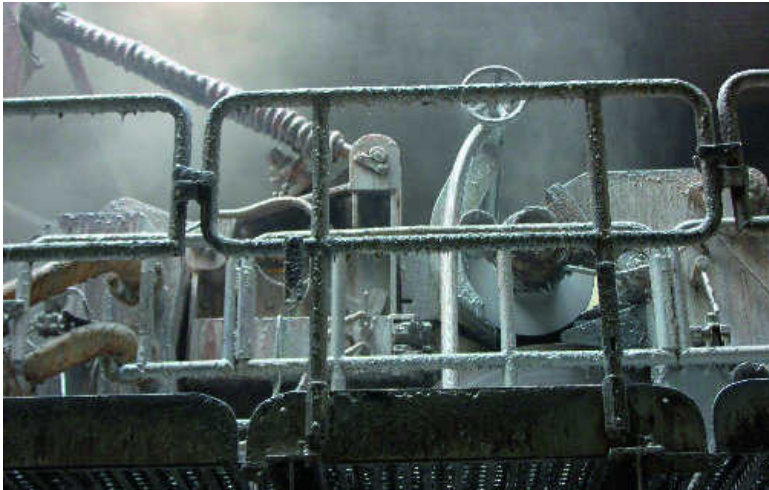
Abb. 2: Gramnegativen Organismen sind auch verantwortlich für schleimbildenden Biofilme auf Anlagen
